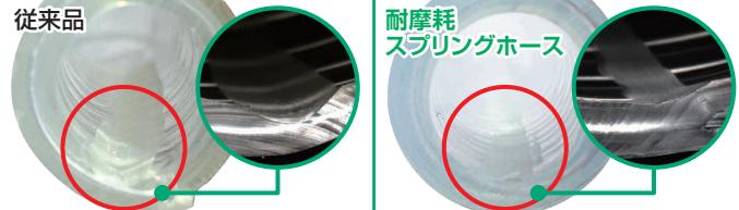
試験方法: ヤスリ(上目58)を1秒=1回の速度で前後1000回、75mm移動させて試料ホース内面を摩耗させる。
